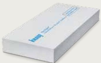
Hydrophile, mineralische und kapillaraktive Dämmplatte, hergestellt aus dem Naturprodukt Perlit und Bindemittel. Speziell für den Anwendungsbereich Innendämmung von Außenwänden und Decken einsetzbar.
