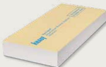
Mineralische und kapillaraktive Dämmplatte, hergestellt aus dem Naturprodukt Perlit und Bindemittel. Speziell für den Anwendungsbereich Innendämmung von Fachwerkaußenwänden einsetzbar.
