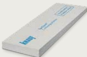
Zur Vermeidung der Wärmebrückenwirkung wird die TecTem® Laibungsplatte als flankierende Dämmung an den Laibungen von Fenstern und Türen sowie bei einbindenden Innenwänden und Decken montiert. Laibungsbereiche sowie einbindende
