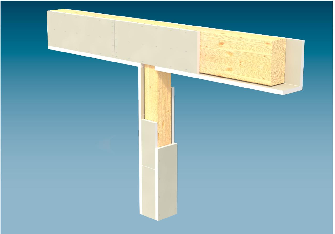
Beim Erhitzen von Holz tritt eine chemische Zersetzung unter Bildung von Holzkohle und brennbaren Gasen ein. Der Verlauf dieser Verkohlung ist abhängig von der Holzart, vom Feuchtegehalt, von der Rohdichte und vom Verhältnis Oberfläche zu Volumen.
