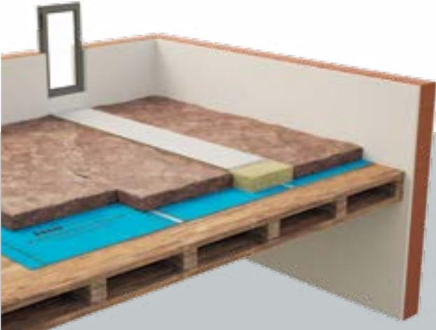
**Der Dachboden mit Laufweg schafft begehbare Zugänge zu Fenstern, Revisionsöffnungen und Anlagen**
