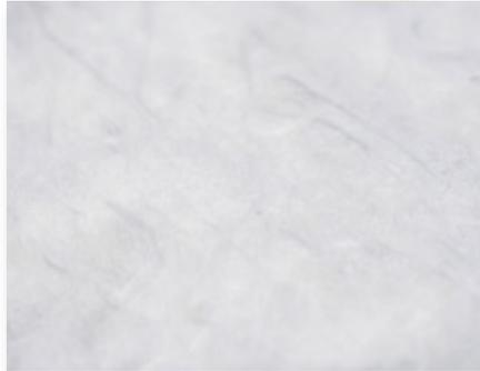
**Mineralisches, nicht brennbares Spezialvlies:** temperaturbeständig bis 1.100 °C.
