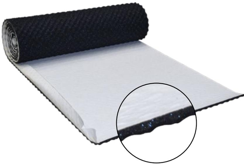
**Bautenschutz & Trittschalldämmung kombiniert:** mit Vlieskaschierung und 3D-Profilierung; für klassische Aufbauten mit Betonplatten in Splittbettung und Wärmedämmung durch PIR, EPS oder XPS (Warm- und Umkehrdach)
