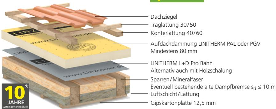
Die Dicke der Aufdachdämmung ist bei dieser Konstruktion abhängig von den wärme- und feuchteschutztechnischen Eigenschaften der raumseitigen Schichten. Je dicker die Aufsparrendämmung, desto sicherer wird der Aufbau. Der Einsatz von PAL oder PGV Aufsparrendämmungen ist bei vorhandenen/neuen Zwischensparrendämmungen bis 160 mm und  $\lambda_B \geq 0,035 \text{ W/(mK)}$  bereits ab einer Dicke von 80 mm möglich.
