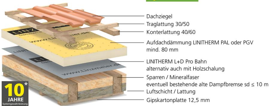
Die Dicke der Aufdachdämmung ist bei dieser Konstruktion abhängig von den wärme- und feuchteschutztechnischen Eigenschaften der raumseitigen Schichten. Je dicker die Aufsparrendämmung, desto sicherer wird der Aufbau. Der Einsatz von PAL oder PGV Aufsparrendämmungen ist bei vorhandenen/neuen Zwischensparrendämmungen bis 160 mm und einer  $\lambda_B \geq 0,035 \text{ W/(mK)}$  bereits ab einer Dicke von 80 mm möglich.
