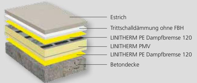
Wärmedämmung unter Estrich mit Fußbodenheizung
