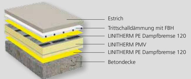
Wärmedämmung unter Estrich gegen Erdreich
