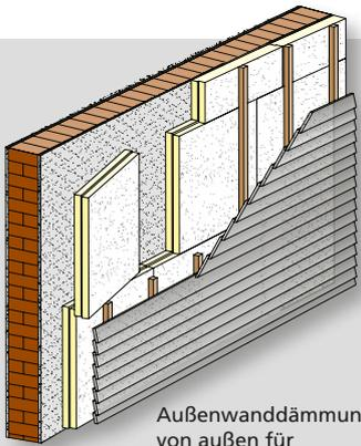
Außenwanddämmung von außen für hinterlüftete Fassade
