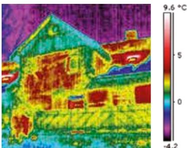
Thermographien zeigen Ihnen die Schwachpunkte Ihrer Hausdämmung. Die roten Flächen stellen Wärmebrücken dar, bei denen die meiste Energie verloren geht.
