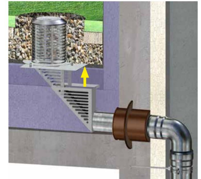
Einsatzbeispiel mit hohem Siebkorb für bekieste Umkehrdächer mit WU-Beton Durchführung
