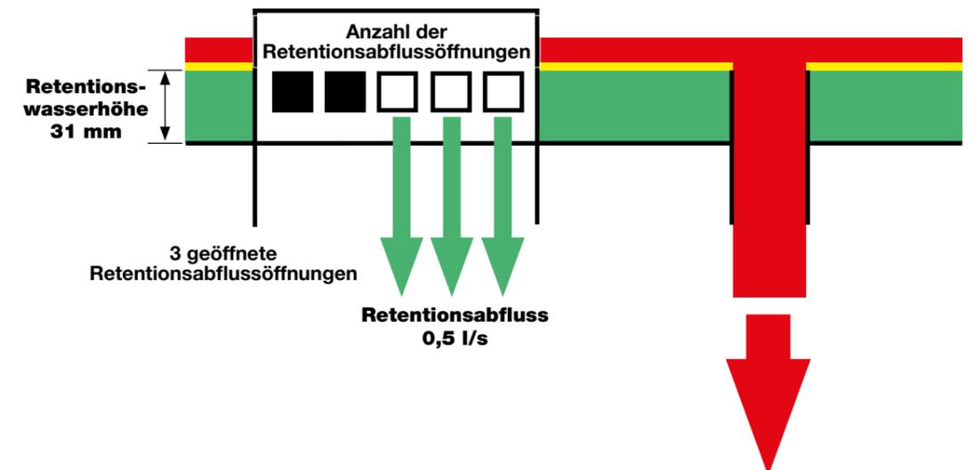
Beispiel: Zur Verwirklichung des Retentionsabflusses 0,5 l/s gemäß Retentionswertetabelle wird der Drehchieber so eingestellt, dass 3 Retentionsabflussöffnungen geöffnet sind.
