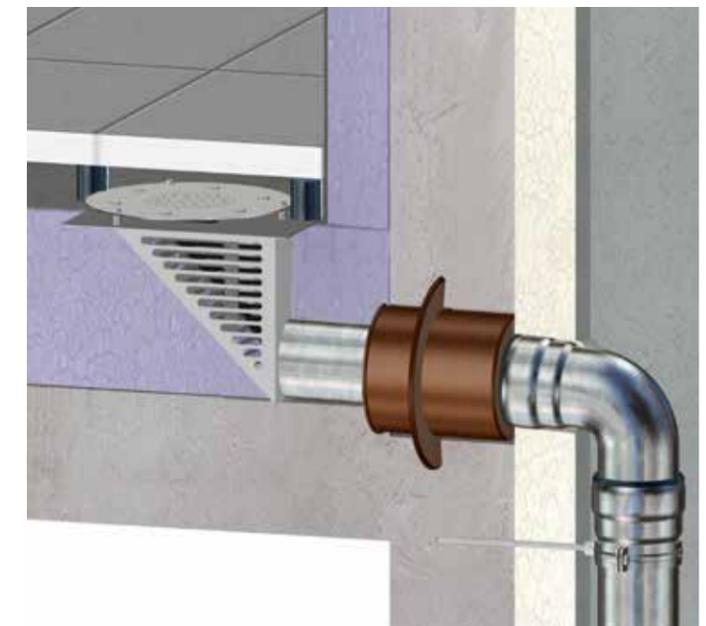
Einsatzbeispiel mit Entwässerungsplatine für Umkehrdächer auf Balkonen und Terrassen mit Platten auf Plattenlager mit WU-Beton Durchführung
