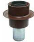
LORO bietet spezielle Rohrdurchführungen mit Sperrflansch für WU-Beton. Vor allem beim bauseitigen Betonieren sorgen Durchführungen mit Sperrflansch für erhöhte Sicherheit, da es bei WU-Beton üblicherweise keine weitere Abdichtungsebene gibt und eventuell eindringendes Sickerwasser durch den umlaufenden Sperrflansch gestoppt wird.
