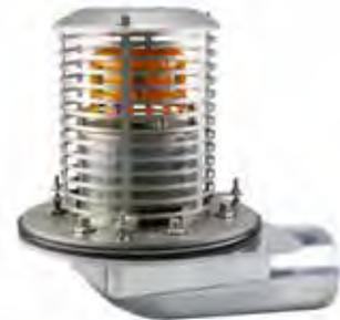
Bei der LORO-X Haupt-Not-Kombi Retentions-Attikaentwässerung mit dem für LORO patentierten Rohr-in-Rohr Prinzip bildet die obere Kante des äußeren Retentionsrohres gleichzeitig die Wehrhöhe für den darauf liegenden Notablauf. Die Notentwässerung erfolgt durch das innenliegende Rohr DN 50.
