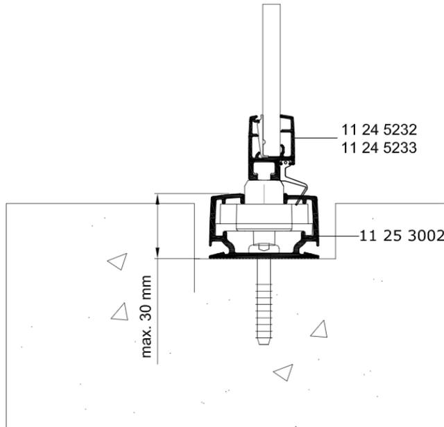
Untere Laufschiene mit Montagewinkel und Wasserableitblech
