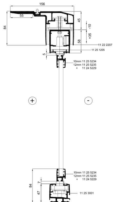
**Dreh-Schiebesystem niedrige Schwelle, Ausgleichsprofil mit Schenkel**
