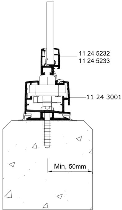
Untere Laufschiene mit Wasserableitblech
