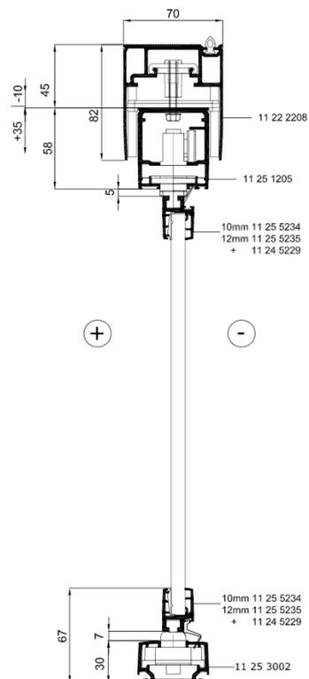
**Dreh-Schiebesystem, Ausgleichsprofil mit Schenkel**
