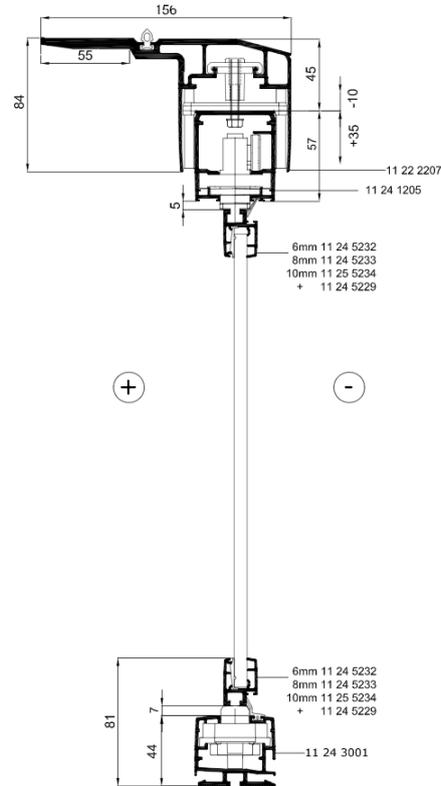
**Dreh-Schiebesystem (stark), Ausgleichsprofil mit Schenkel**
