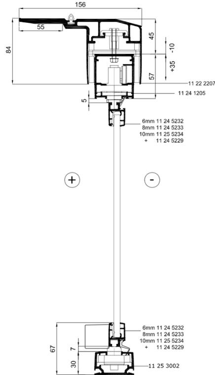
**Dreh-Schiebesystem (stark) niedrige Schwelle, Ausgleichsprofil mit Schenkel**
