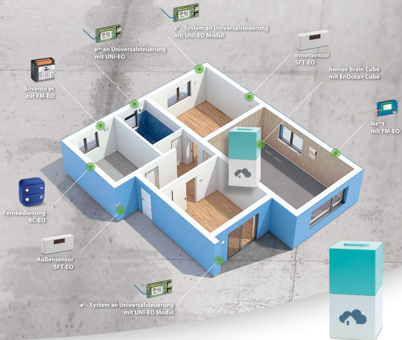
Die bidirektionale Funktechnologie versendet zuverlässige Signale mit sehr geringen Mengen an Energie. Die Sender können zu einem Teil batterieless und somit wartungsarm betrieben werden. Die notwendige Energie wird über die Piezoelektrizität von Schaltern oder aus Solarzellen generiert.
