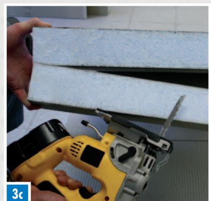
Dicken bis 100 mm lassen sich mit dieser Technik sauber durchtrennen. Besonders geeignet ist die Stichsäge auch für den Zuschnitt von Konturen und Kurven.
