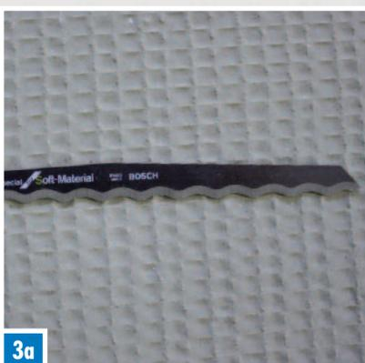
Wir empfehlen für einen sauberen Zuschnitt mit der Stichsäge ein Wellensägeblatt (z.B. Typ Bosch T313AW HCS).
