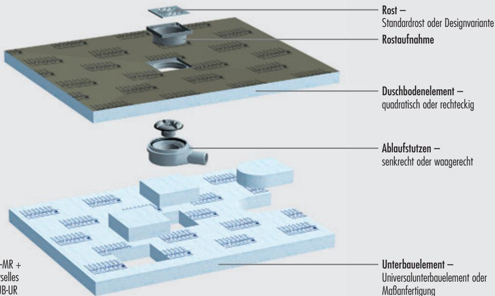
Abbildung zeigt TUB-MR + TUB-BAW-S + universelles Unterbauelement TUB-UR
