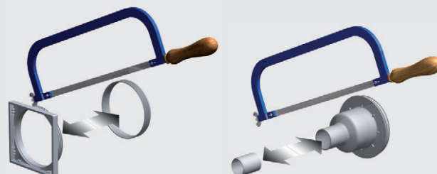
Rostaufnahme – universelle Höhenanpassung an Fliesenstärke
