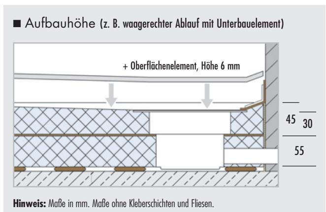
■ **PRODUKTDATEN – LUX ELEMENTS®-TUB-LINE FINISH**
