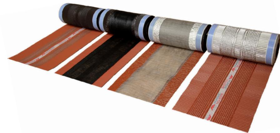
Das Produkt hat auf feuchtem Untergrund im Vergleich zum herkömmlichen Kleben zunächst eine ausreichende Anfangshaftung. Es erreicht allerdings selbständig seine Endfestigkeit ohne zusätzliches Andrücken bzw. Anformen. Kleben und liegen lassen. Bereits nach ca. dreißig Minuten erfolgt eine belastbare Anhaftung. Nach etwa einem Tag (je nach Witterung) wird seine Endfestigkeit erreicht.
