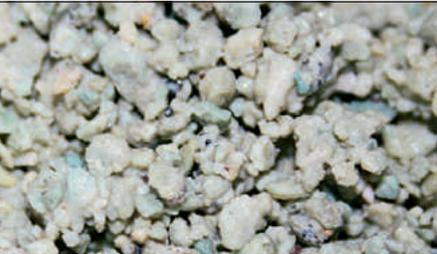
**ViaSorp ist ein naturnahes, homogenes Adsorbens, das speziell für die Anwendung in der Niederschlagswasserbehandlung entwickelt wurde und hergestellt wird. Die natürlich gewonnenen Zeolithe werden konditioniert, damit sie mehr Schmutzstoffe aufnehmen als dies im naturbelassenen Zustand der Fall wäre. Verwendet wird ViaSorp in den bauaufsichtlich zugelassenen Anlagen ViaPlus, den Sickerschächten ViaFil und den Gewässerschutzanlagen ViaGard.**
