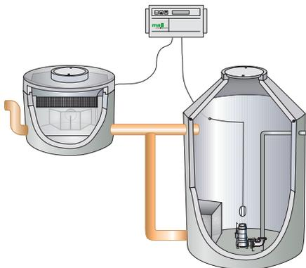
Unabhängig von der Einstufung der aufnehmenden Gewässer soll das Regenwasser von besonders stark verschmutzten Flächen möglichst in die Schmutzwasserkanalisation eingeleitet werden. Dies ist in vielen Fällen nicht möglich, zumindest nicht solange der Regen andauert. Für diese Fälle kommt der Einsatz einer Schmutzfangzelle in Betracht.
