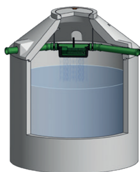
Zu- und Ablaufhöhe 620 mm unterhalb der Schachtabdeckung
