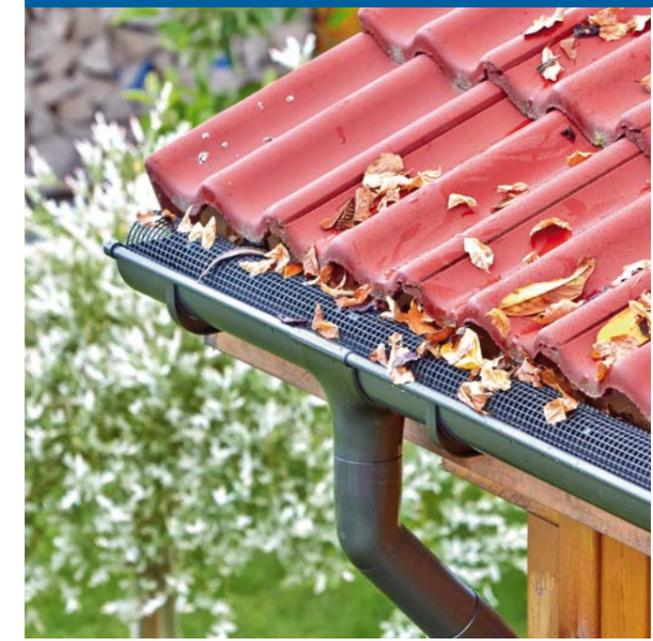
**Marley Poly-Net Laubstop** legen Sie einfach in die Dachrinne – und Laub hat keine Chance mehr. Es bleibt auf der runden Oberfläche liegen, trocknet ab und wird vom Wind weggeweht. Marley Poly-Net Laubstop aus Polyäthylen (PE) ist bruchstark, korrosionsbeständig, temperaturbeständig und zu 100 % recycelbar. Für Dachrinnen RG 150-180, RG 100-125 und Kastendachrinnen (bis RG 100).
