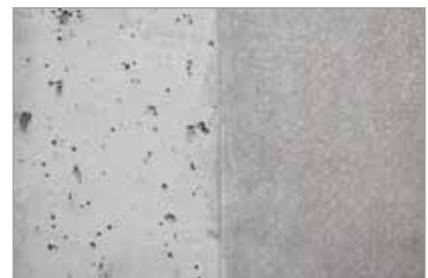
ohne Zemdrain® (links) vs. mit Zemdrain® (rechts)
