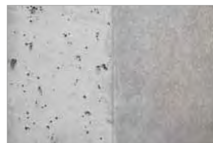
ohne Zemdrain® (links) vs. mit Zemdrain® (rechts)
