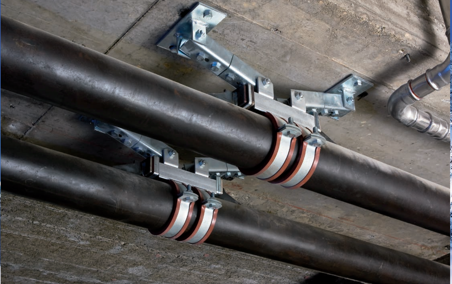
Befestigung warmgehende Leitung, Stahl Festpunkt Typ A mit Gelenkhalter
