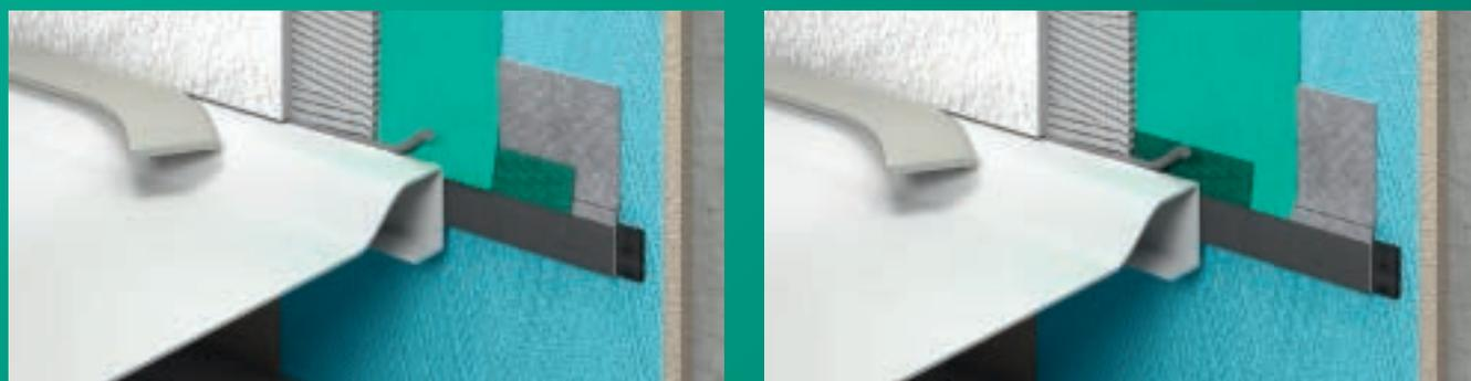
Angebracht wird der MEPA Schnittschutz entweder direkt auf Aquaproof (links) oder auf die letzte Schicht der Verbundabdichtung (rechts).
