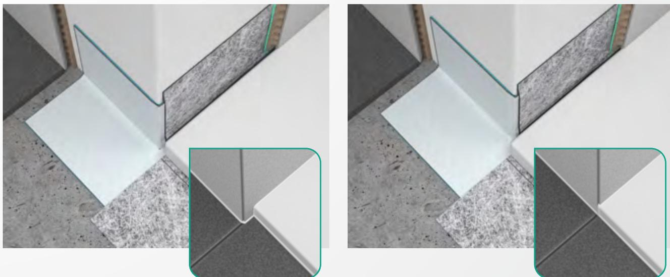
Setzt du die Wanne bündig zur Rohwand an, entsteht nach dem Verfliesen ein kleiner Versatz, der sich durch die Stärke von Abdichtung, Fliesenkleber und Fliese ergibt.
