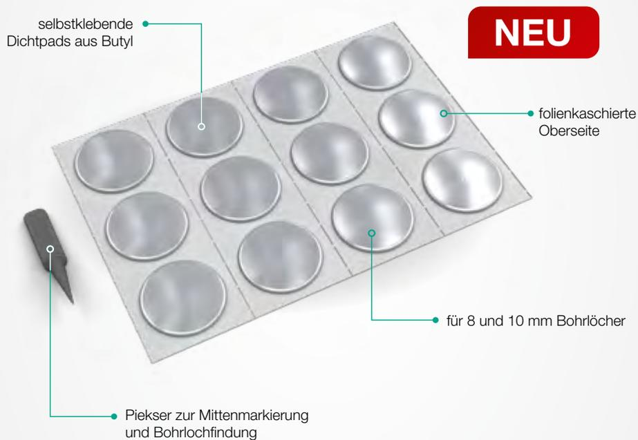
Das Butylpad wird mithilfe des Pieksters mittig über dem Dübel platziert und fest an den Untergrund gedrückt. Das Gewinde der Schraube zieht das Butyl beim Eindrehen mit in den Dübel und verschließt auch von oben das Bohrloch.
