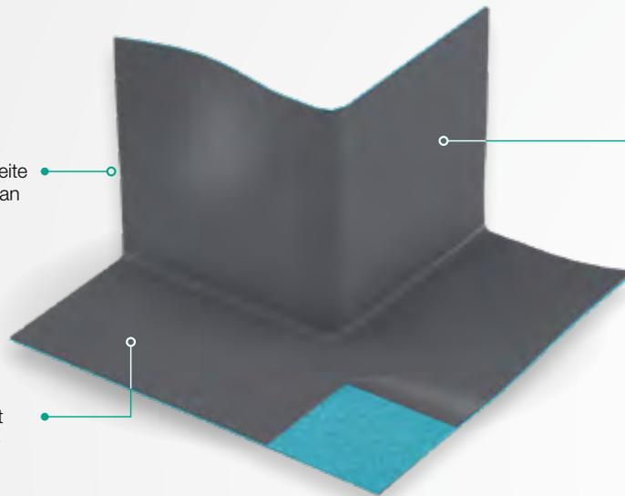
Die oberseitigen Butylflächen dienen zur wasserdichten Verbindung der V-Ecke mit dem Wannendichtband Aquaproof im Wand- und Bodenbereich; nicht genutzte Verbindungsflächen deckst du einfach mit den beliegenden Vliespads ab
