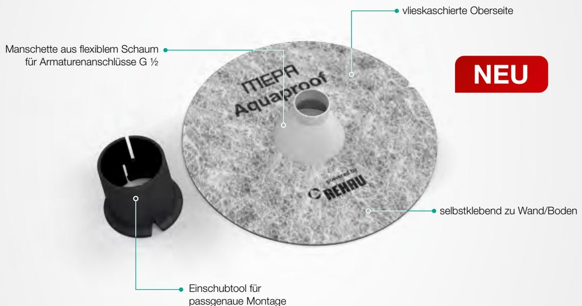
Die Abdichtung erfolgt direkt an der Wandscheibe oder Hahnverlängerung. Mit dem Set können maximale Tiefen von der Oberkante der Abdichtungsebene bis zum Beginn der Wandscheibe von 20 mm realisiert werden. Bei größeren Abständen wird die Manschette an einer Hahnverlängerung montiert.
