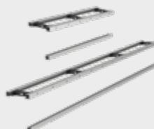
Besonders praktisch für die Schienenmontage vor Massiv- oder Ständerleichtbauwänden: fertig konfigurierte Montagesets in 150 cm oder 300 cm Länge mit einer stufenlosen Bautiefenverstellung zwischen 110 und 280 mm.
