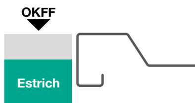
Hauptbestandteil des Aquaproof 3D sind neben dem Butyl-Dichtband die 3D-Ecken, die für die sichere Abdichtung der verschiedenen Übergänge am bzw. mit dem Boden sorgen.
