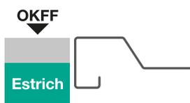
Für den bodengleichen Einbau wird das Wannenabdichtband Aquaproof durch die Aquaproof-Ecken ergänzt, die für die sichere Abdichtung der verschiedenen Übergänge am bzw. mit dem Boden sorgen.
