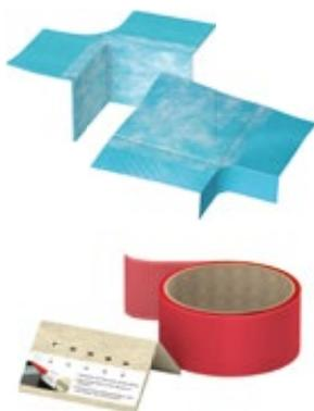
Bei bodengleich eingebauten Wannen wird das Aquaproof einmal komplett um den Wannenkörper geführt und mit einer Überlappung von 50 mm dauerhaft dicht geschlossen. Die **Aquaproof 3D Bodengleich**-Ecken werden von außen an das Wannenabdichtband angebracht und geben der Abdichtung die richtige Passform für die jeweilige bodengleiche Einbausituation. Die 3D-Ecken sind durch die vorgegenuteten Laschen flexibel und vielseitig einsetzbar.
