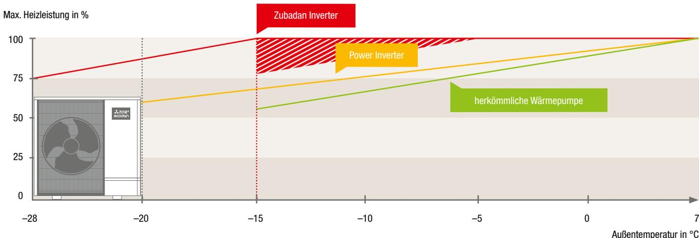
Mit zuverlässigem Wärmepumpenbetrieb selbst bei  $-28$  °C und voller Heizleistung bis  $-15$  °C verfügt die patentierte Zubadan Inverter-Technologie über ein deutlich größeres Leistungspotenzial als herkömmliche Systeme.
