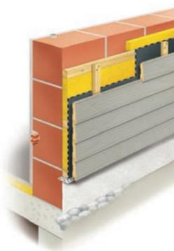
Wandaufbau der Massivbauweise.
