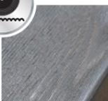
**Microriffelung:** Durch sehr fein gezackte Hobelmesser entsteht eine geriffelte Oberfläche, die eine gleichmäßigere und höhere Farbaufnahme von Dünnschichtlasuren ermöglicht.
