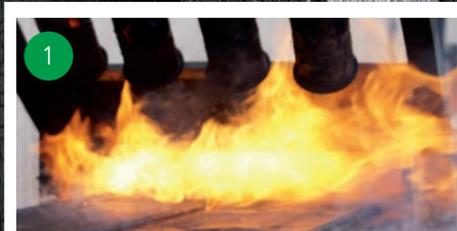
**1** Die von MOCOPINUS betriebene Beflammungsanlage gewährleistet eine exakte Steuerung aller Prozessparameter. Das ist die beste Grundlage für gleichbleibend hohe Qualität und ein reproduzierbares Ergebnis bei jeder Behandlungsart.
