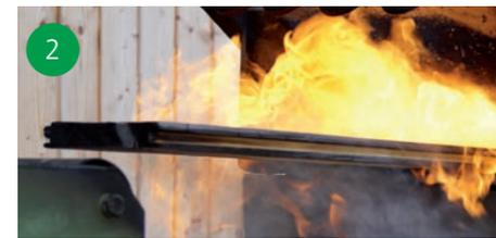
**2** Für die verschiedenen Endprodukte wird der Karbonisierungsprozess individuell angepasst – teilweise in mehreren Schritten vorgenommen.
