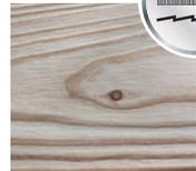
**Strukturierte Oberfläche:** Als Grundlage dient eine gehobelte Oberfläche. Diese wird intensiv mit mehreren Bürsten bearbeitet. Da Weichhölzer wie Fichte weiche und harte Jahresringe besitzen, bürsten sich diese unterschiedlich stark aus. Es entsteht eine „wellige“ Oberfläche mit sehr deutlicher, plastischer Holzstruktur.
