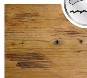
**Gehackte Oberfläche:** Eine gehobelte Oberfläche wird mit wenigen Messern sehr flach und langsam bearbeitet. Das gleiche Prinzip wendeten Zimmerer schon vor Jahrtausenden an, um Balken zu behauen. Hierdurch entsteht eine außerordentlich interessante Holzoberfläche.
