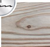
**Strukturierte Oberfläche:** Als Grundlage dient eine gehobelte Oberfläche. Diese wird intensiv mit mehreren Bürsten bearbeitet. Da Weichhölzer wie Fichte weiche und harte Jahresringe besitzen, bürsten sich diese unterschiedlich stark aus. Es entsteht eine „wellige“ Oberfläche mit sehr deutlicher, plastischer Holzstruktur.
