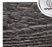
**Karbonisierte Oberfläche:** Durch kontrolliertes Beflammen entsteht eine Holzkohleschicht mit sehr interessanter und lebhafter Optik, die je nach Holzart unterschiedlich ausfällt.
