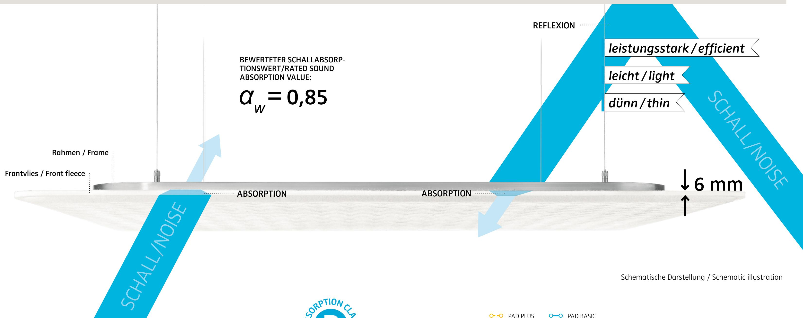
Schematische Darstellung / Schematic illustration
