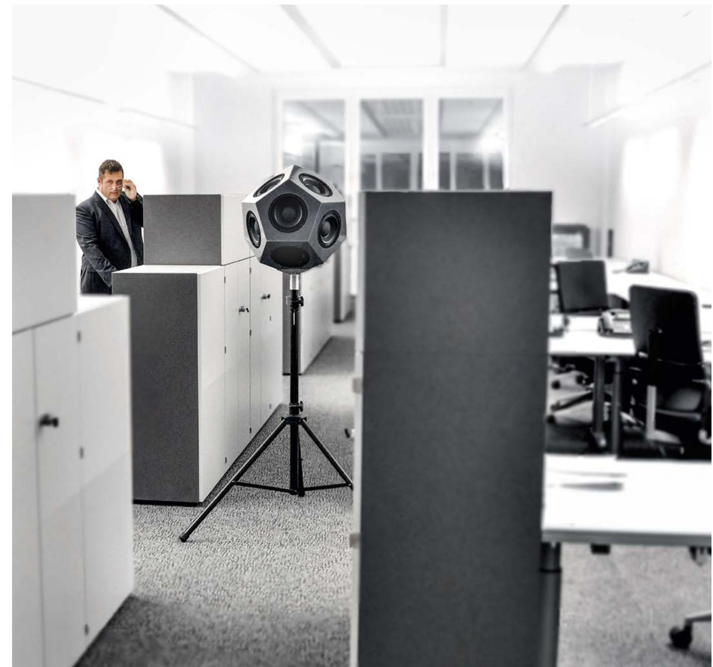
Akustiker von Rossoacoustic im Einsatz mit leistungsfähigem Kugellautsprecher (Dodekaeder) zur akustischen Vermessung eines Büorraumes.
