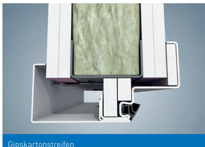
Intumeszierendes Brandschutzmaterial, das bei Feuer aufschäumt und den Zwischenraum zwischen Zarge und Wand zuverlässig abdichtet und damit brand-schutztechnisch schützt.
