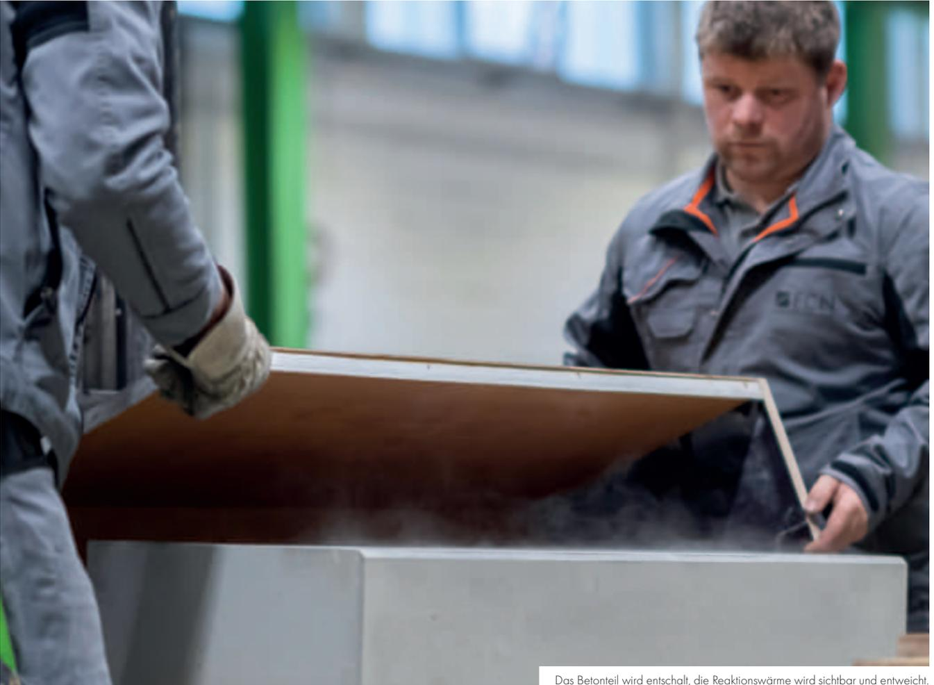
Das Betonteil wird entschalt, die Reaktionswärme wird sichtbar und entweicht.
