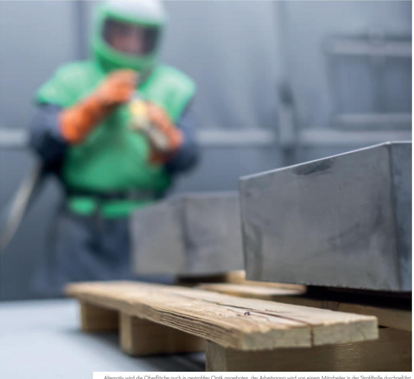
Alternativ wird die Oberfläche auch in gestrahlter Optik angeboten, der Arbeitsgang wird von einem Mitarbeiter in der Strahlhalle durchgeführt.
