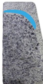
Durch Frostereignisse kommt es zu innerer Gefügezerstörung und endgültigem Versagen
