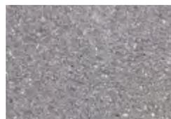
**feingestrahlt** – Natursteinvorsatz, der auf der Oberfläche fein kugelgestrahlt wird
