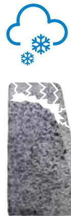
Durch Frostereignisse kommt es zu innerer Gefügenderstörung und endgültigem Versagen
