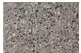
**geschliffen** – Natursteinvorsatz, der auf der Oberfläche geschliffen wird
