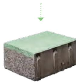
Bei **AirClean® Level 3** verbinden wir die Vorteile von „1“ und „2“ – dem Höchstmaß der Schadstoffreduzierung. Um kurzfristig hohe Abbauraten zu erzielen wird der Photokatalysator TiO<sub>2</sub> zum einen werkseitig als Beschichtung aufgetragen und zum anderen dauerhaft in die Betonmatrix (Vorsatzbetonschicht) eingebunden.
