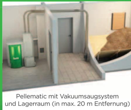
Pellematic mit Vakuumsaugsystem und Lagerraum (in max. 20 m Entfernung)
