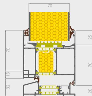
Querschnitt des Türrahmens mit einer Stärke von 90 mm samt Flügel. Füllung mit einer Stärke von 70 mm. Abbildung mit zusätzlichen Isolationseinsätzen im Flügel und Blendrahmen.
