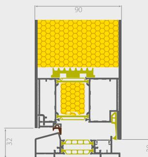
Querschnitt des Türrahmens mit einer Stärke von 90 mm samt Flügel. Füllung mit einer Stärke von 76 mm. Abbildung mit zusätzlichen Isolationseinsätzen im Flügel und Blendrahmen.
