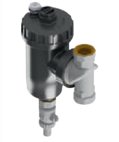
Magnetischer Multifunktions-Schlammabscheider aus Polymer, Anschlußstück aus Messing, Anschlüsse entweder 3/4" IG oder 1" IG, inklusive Entleerhahn
