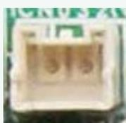
Anschlusstecker mit Litzen (2.000 mm) zur Ansteuerung eines externen Lüftungsgeräts oder EC-Ventilators
