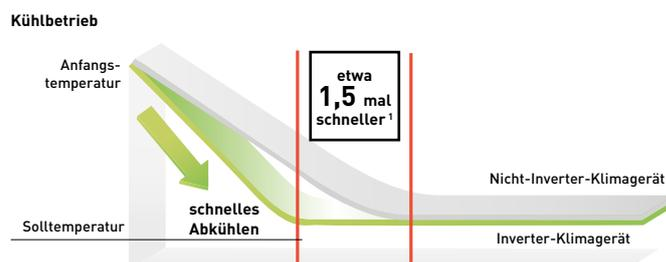
1) Vergleich von je einem Inverter- und Nicht-Inverter-Gerät mit 3,5 kW. Außentemperatur: 35 °C; Solltemperatur: 25 °C
