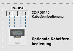
Spannungsversorgung je nach Modell über das Innengerät oder Außengerät (s. Tabelle).
