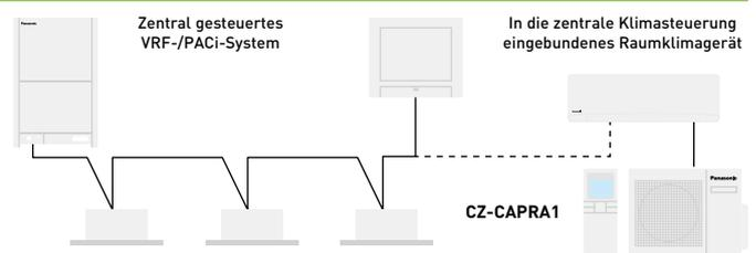
**Grundfunktionen:** Ein/Aus-Schaltung, Betriebsartenwahl, Solltemperatur, Ventilator Drehzahl, Lamelleneinstellung, Sperre der Fernbedienung.
