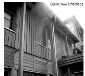
Abb. 1 Blower-Door-Prüfverfahren mit Unterdruck...
