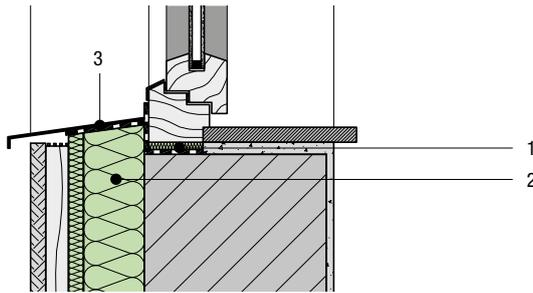
1. Dämmstoff, 10 mm
