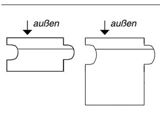
Abb. 6 Profilierung PAVATHERM-PLUS
