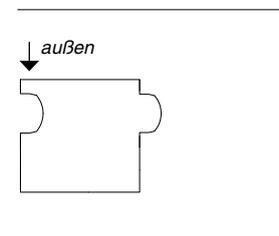
Abb.7 Profilierung ISOLAIR ab 100mm
