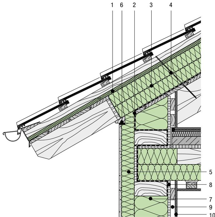
1. ISOLAIR/ISOROOF oder PAVATHERM-PLUS Unterdeckplatte
