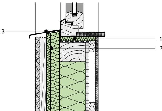
1. Druckfeste Dämmschicht, 20 mm
