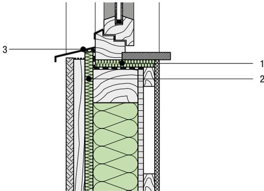
1. Druckfeste Dämmschicht, 20 mm
