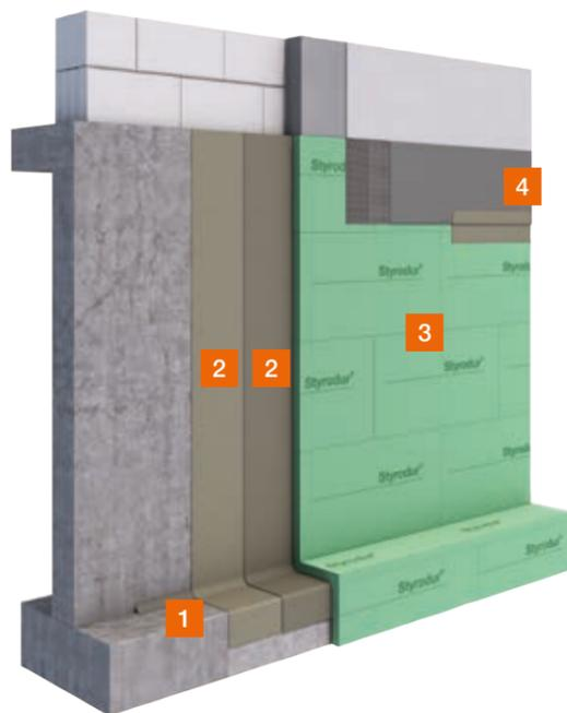
Neben der klassischen bituminösen Abdichtung haben sich auch Abdichtungen mit flexiblen mineralischen Dichtschlämme (MDS) durchgesetzt. Flexible mineralische Dichtschlämme sind leicht aufzubringen und schnell abbindend. Insbesondere bei der Sanierung spielt die flexible mineralische Dichtschlämme ihre Stärken aus, da sie selbst auf alten Bitumenabdichtungen haftet.
