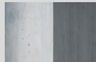
PCI Barrafill® L: in Hell und Dunkel verfügbar zum Einstellen der gewünschten Betonfarbe
