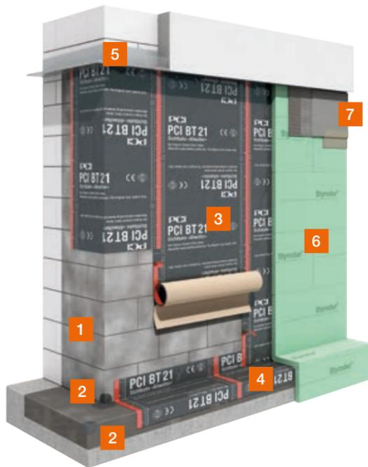
Die Kaltselbstklebebahnen (KSK) waren bereits Bestandteil der Norm und sind auch als Stoffgruppe in die neue DIN 18533 Teil 2 (Abdichtung mit bahnenförmigen Abdichtungsstoffen) aufgenommen. KSK-Bahnen sind für Bodenfeuchte und nicht drückendes Wasser sowie im Sockelbereich zugelassen. Die Bahnen sind mind. 8 cm zu überlappen und die Stöße müssen fest angedrückt werden.
