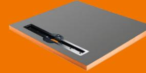
Das Duschelement PCI PowerBoard® Linea hat einen eingearbeiteten linienförmigen Bodenablauf. Sein neuer formstabiler Kern aus XPS, beidseitig mit Spezialmörtel und Glasfasergewebe beschichtet, macht das Duschelement noch fester und absolut wasserdicht nach DIN 18534-6.
