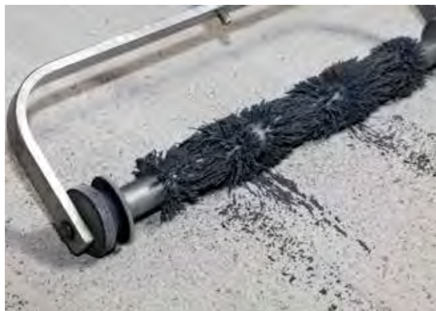
Magnetrolle zum Einsammeln von liegen gebliebenem Strahlgut
