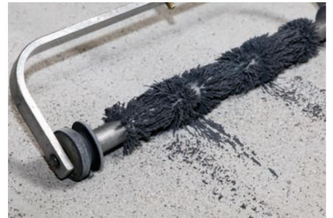
Magnetrolle zum Einsammeln von liegen gebliebenem Strahlgut
