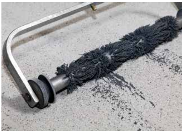
Magnetrolle zum Einsammeln von liegen gebliebenem Strahlgut
