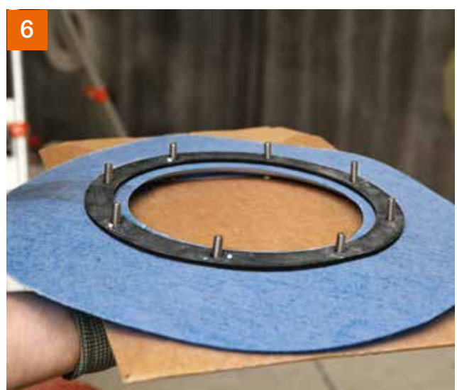
6 Schon ist der selbstgebaute Klebeflansch fertig zum Einbau.
